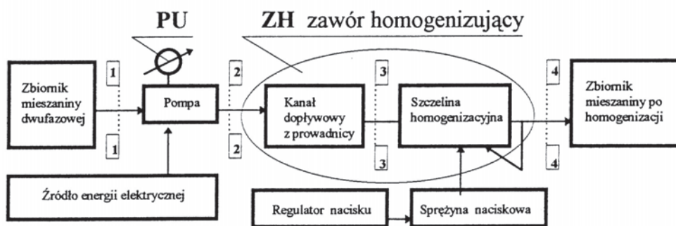
Rys.1 Schemat homogenizatora ciśnieniowego gdzie: PU – pompa, ZH – zawór homogenizujący [5]
