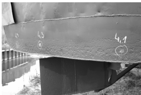
Rys. 4. Uszkodzenia korozyjne pawęży
