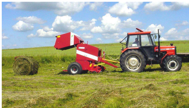
Rys. 4. Prasa Z 562 z ciągnikiem „URSUS” 5314 w położeniu roboczym – podczas zbioru podwiedniętej trawy z przeznaczeniem na sianokiszonkę
