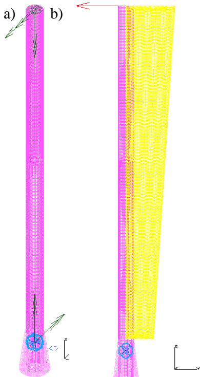
Rys. 4. Implementacja obciążeń w modelu obliczeniowym: a) obciążenia od pracy śmigła; b) obciążenia od ciśnienia wiatru
