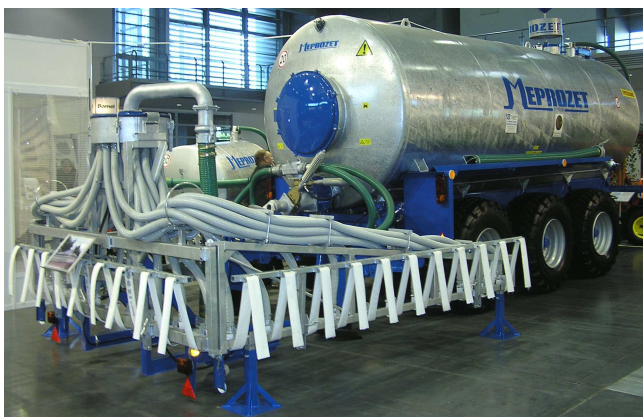
Rys. 1. Wóz asenizacyjny PN-200 (PN 2/20) produkcji MEPROZET KOŚCIAN S.A., Kościan Fig. 1. PN-200 (PN 2/20) Slurry Tanker manufactured by MEPROZET KOŚCIAN S.A., Kościan (Poland)
