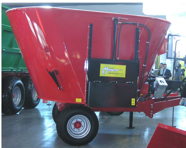
Rys. 4. Typoszereg wozów paszowych z jednym mieszadłem typu WP 6 – WPP 15 produkcji Zakładu Mechanicznego METALTECH Sp. z o.o., Mirosławiec
