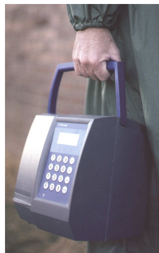
Rys. 5. Licznik komórek somatycznych DCC produkcji DeLaval International AB, Szwecja
