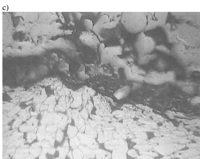
Rys. 5. Struktury powłok regeneracyjnych na próbkach: a) SP – szlifowanej papierem ściernym, b) NSK – nagniatanej śrutem kulistym, c) NSŁ – nagniatanej śrutem łamanym. Pow. 200x Fig. 5. Structure of regenerative coatings on specimens: a) SP – after grinding by glass-paper, b) NSK – after ball peening, c) NSŁ – after shot peening by cut wire shot
