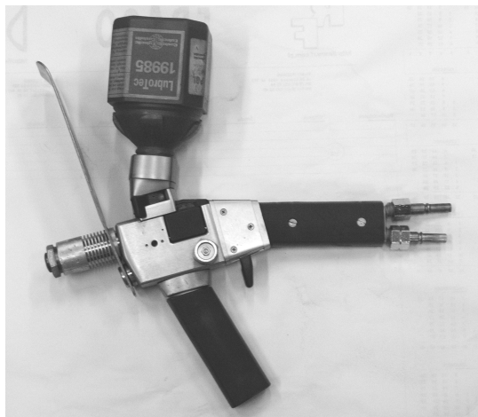
Rys. 1. Palnik do natryskiwania gazowo-proszkowego Roto-Tec 80 firmy Castolin Eutectic
