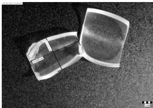
Fot. 3 Produkt pianowy, zbieracz 8% NaOH, temperatura 100°C
