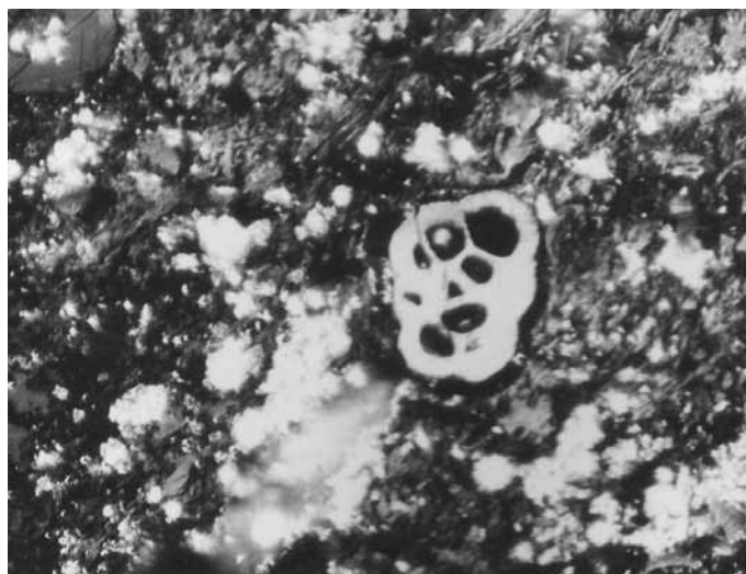
Rys. 2 Poszczerpiony sklerotynit, rezynit z FeS_2 i formy framboidalne densynitu
