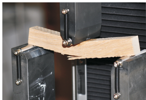
Rysunek 9 Zginanie trzy punktowe próbki drewna dębu
