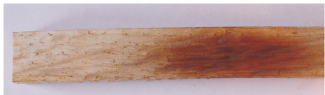
Rysunek 8 Próbka drewna zniszczona na skutek działania niejednorodnego pola magnetycznego
