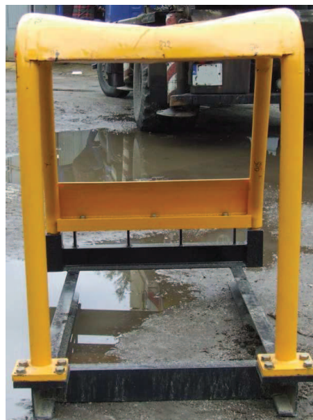
Rys.10. Odkształcenie poszycia górnego konstrukcji ochronnej [1]
