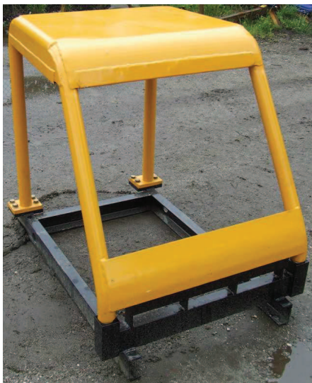
Rys.5. Konstrukcja kabiny operatora przeznaczona do badań niszczących [1]
