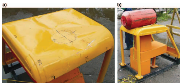
Rys.9. Efekt uderzenia obciążnika w konstrukcję ochronną: a) wgniecenie poszycia górnego, b) obciążnik na poszyciu górnym [1]
