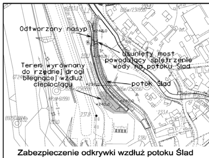
Rys. 14. Lokalizacja zabezpieczeń przy ujściu potoku Śład
