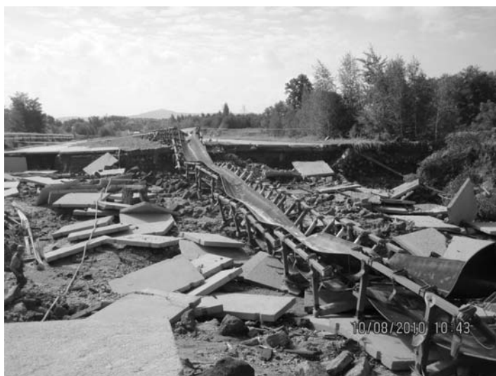
Rys. 5. Wdarcie się wody do odkrywki z rz. Miedzianki w rejonie ciągu ON-3
