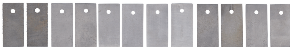
Rys. 2. Wygląd kuponów korozyjnych ze stali P-110 badanych w temperaturze 20 °C i w czasie 7 dni: a) przed badaniem; b) po badaniu
