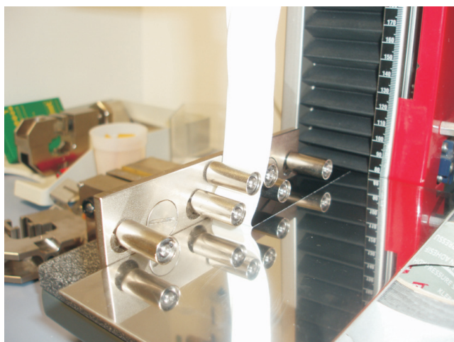
Figure 4 Peel adhesion measurement on steel under angle 90° according to AFERA 4001 Rysunek 4 Pomiar adhezji na płytce stalowej pod kątem 90° wg metody AFERA 4001
