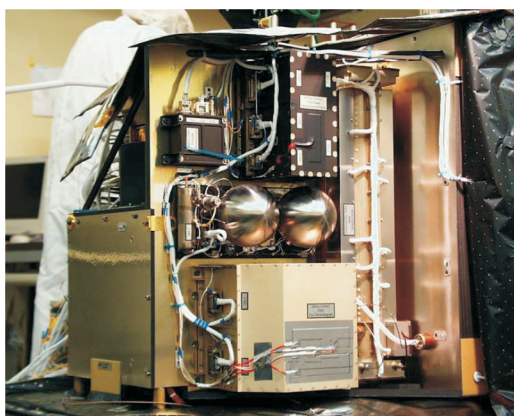
Rysunek 5 Urządzenie badawcze (COSAC) stosowane w misji Rosetta. W środku widoczne są dwa zbiorniki gazu nośnego, na górze jest skrzynka układów elektronicznych, po prawej stronie znajduje się spektrometr mas a na dole termostat z kolumnami. Urządzenie ma 400 mm szerokości i 500 mm wysokości [4]
