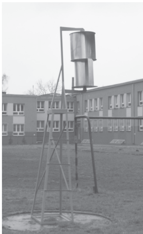
Rysunek 2 Widok stanowiska badawczego z zamontowanym wirnikiem Savoniusa'a typu duble
