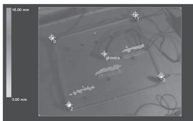
Rysunek 5 Obraz z naniesioną mapą wad oraz wykrytą głowicą i markerami [9]
