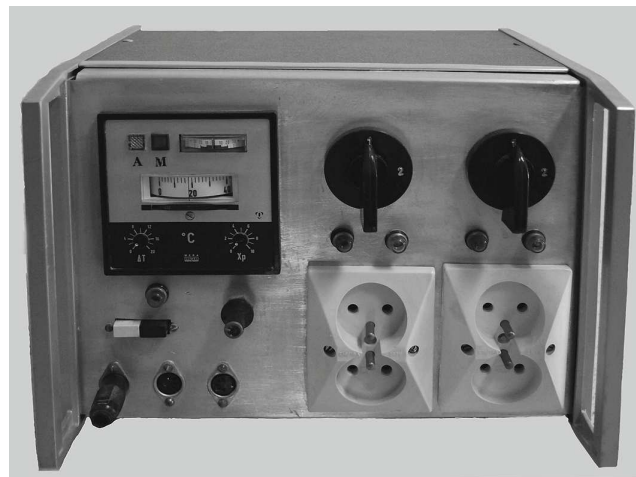
Rysunek 9. Stabilizator temperatury grzejników zaworu sześciodrożnego i kapilary dozowniczey
