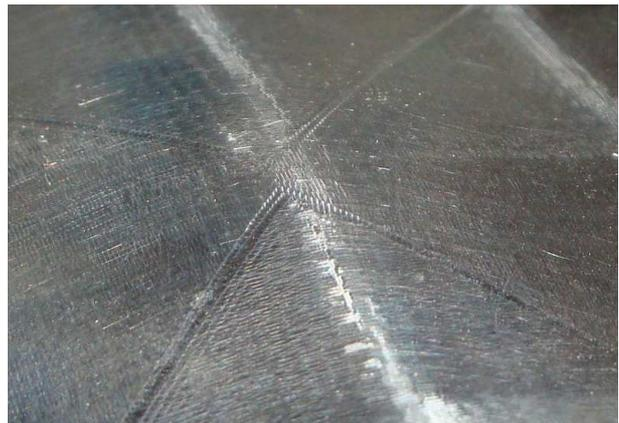
Rysunek 9. Strategia po tworzących – widok wytworzonej powierzchni (widoczne ślady obróbki wynikające z nagłych zmian kierunku ruchu narzędzia przy jednoczesnych zmianach wartości posuwu)
