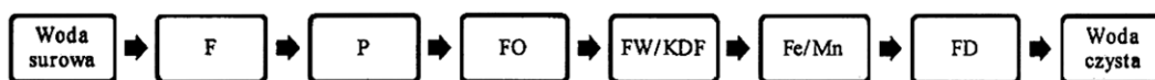
Rysunek 1. Schemat badawczego przenośnego ciągu wodnego: F – wstępny filtr zgrubny; P – pompa;
