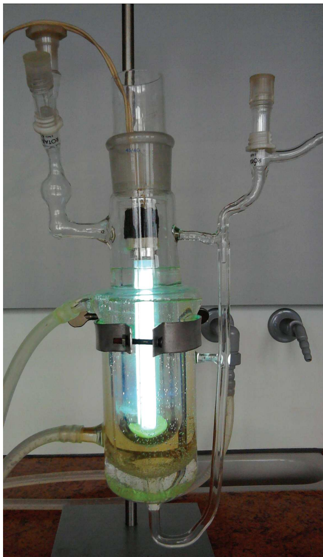
Rysunek 4. Reaktor z wewnętrznym źródłem promieniowania (niskociśnieniowa lampa rtęciowa o mocy 9 W) stosowany w laboratorium Zakładu Fizyki Chemicznej Instytutu Chemii UJK
