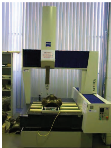
Rys. 2. Współrzędnościowa maszyna pomiarowa Zeiss ACCURA 7 (a) oraz głowica pomiarowa VAST XT (b)
