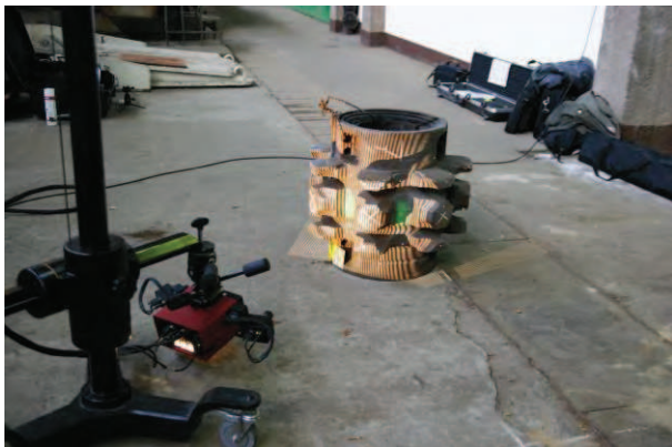
Rys. 14. Projektcja światła strukturalnego na powierzchnię skanowanego bębna
