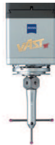
Rys. 2. Współrzędnościowa maszyna pomiarowa Zeiss ACCURA 7 (a) oraz głowica pomiarowa VAST XT (b)
