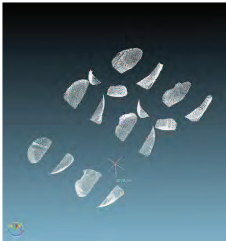
Rys. 10. Etap 7 – Chmura punktów pomiarowych dla czterech przykładowych gniazd bębna łańcuchowego
