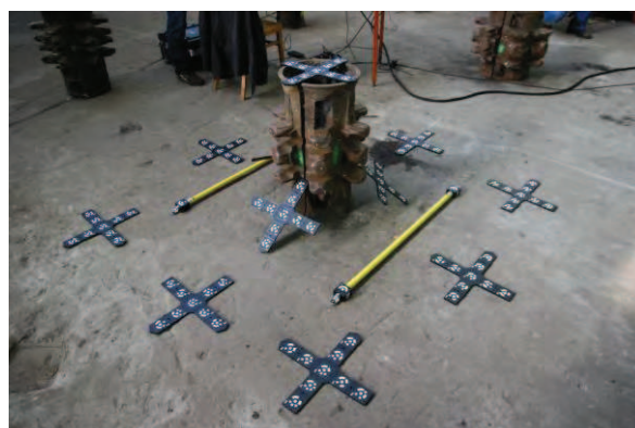
Rys. 13. Bęben łańcuchowy przygotowywany do pomiarów – z naklejonymi znaczkami kontrolnymi w otoczeniu zestawu markerów
