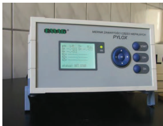
Rys. 13. Miernik zawartości części niepalnych PYLOX Рис. 13. Измеритель содержания негорючих частиц PYLOX
