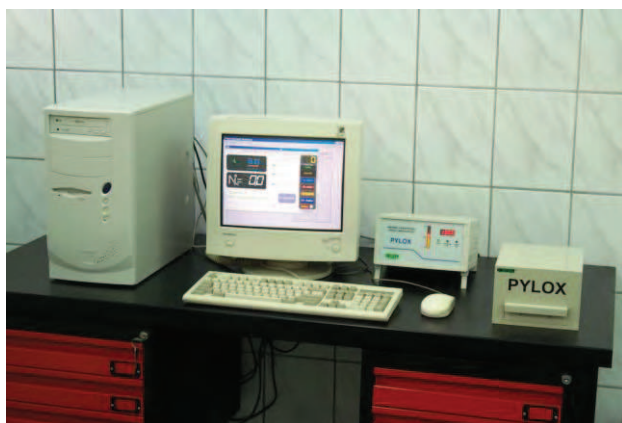
Rys. 13. Miernik zawartości części niepalnych PYLOX Рис. 13. Измеритель содержания негорючих частиц PYLOX
