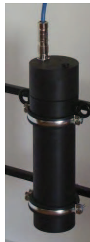
Rys. 19. Widok popiołomierza drugiej generacji MPOF II Рис.19. Вид золомера второго поколения MPOF II
