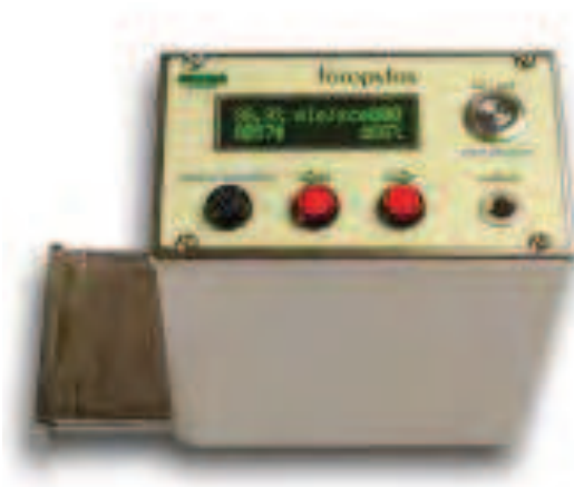
Rys. 15. Przenośny miernik zawartości części niepalnych FOTOPYLOX Рис. 15. Переносной измеритель содержания негорючих частиц FOTOPYLOX
