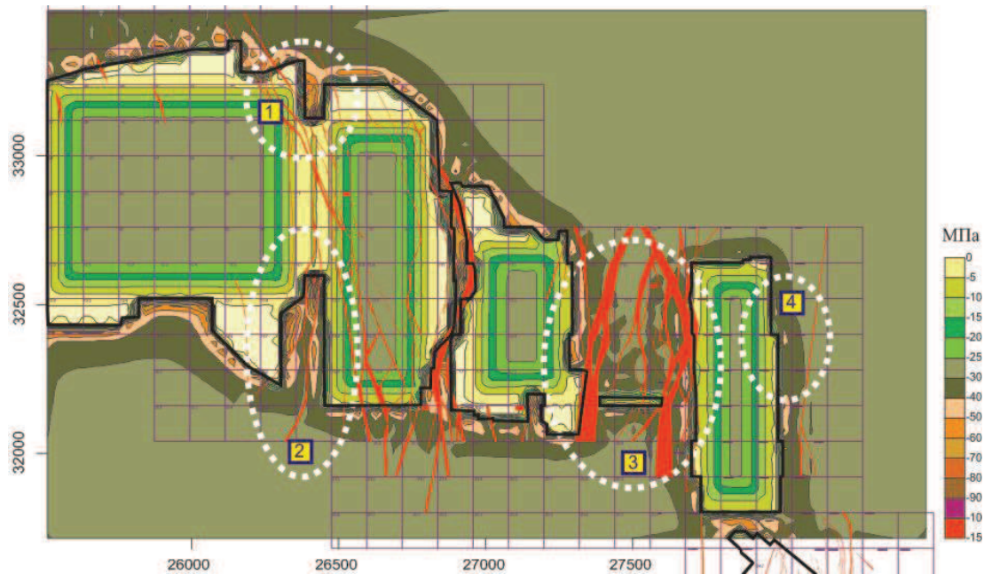
Rys. 4. Regionalny rozkład naprężeń ściskających w masywie złoża rudy Рис. 4. Региональное распределение сжимающих напряжений в рудном массиве
