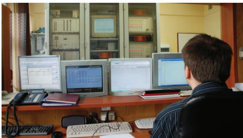
ARES 5/E – sejsmoakustyczny system wykrywania zagrożeń tąpnięciami ARES 5/E – сейсмоакустическая система оценки удароопасности
