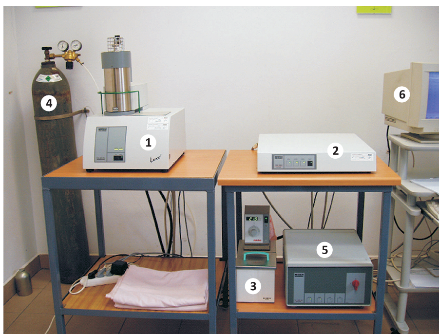
Rysunek 2. Stanowisko do badań derywatograficznych (1 – piec, 2 – jednostka sterująca, 3 – termostat, 4 – butla z N 2 , 5 – układ zasilania, 6 – stanowisko z oprogramowaniem do zbierania danych)
