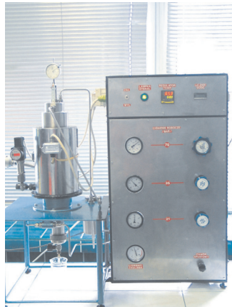
Rys. 5. Aparat do badania migracji gazu przez wiązany zaczyn cementowy (konstrukcja INiG)
