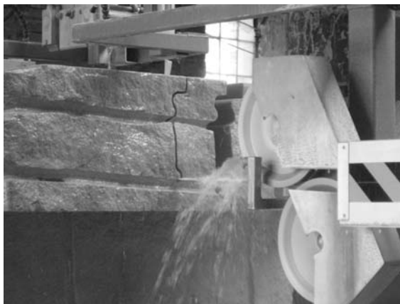
Rys. 4. Wycinanie z bloku elementu krzywoliniowego trakiem linowym (fot. W. Glapa)
