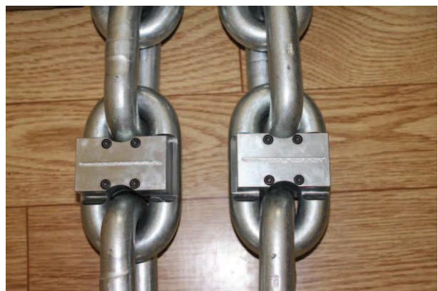
Rys. 4. Układ do pomiaru obciążenia dynamicznego w łańcuchu zgrzeblowym przenośnika zgrzeblowego (dwa ogniwa pomiarowe zintegrowane z rejestratorami)
