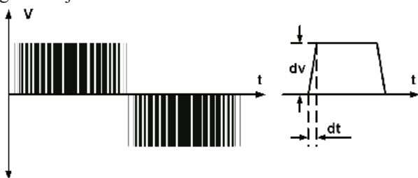
Rys. 4. Napięcie wyjściowe falownika z modulacji MSI
