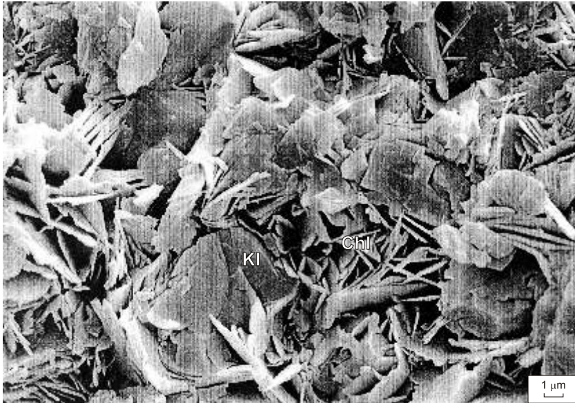
Fig. 12. Kaolinit (Kl) przeobra any w chloryt (Chl)
