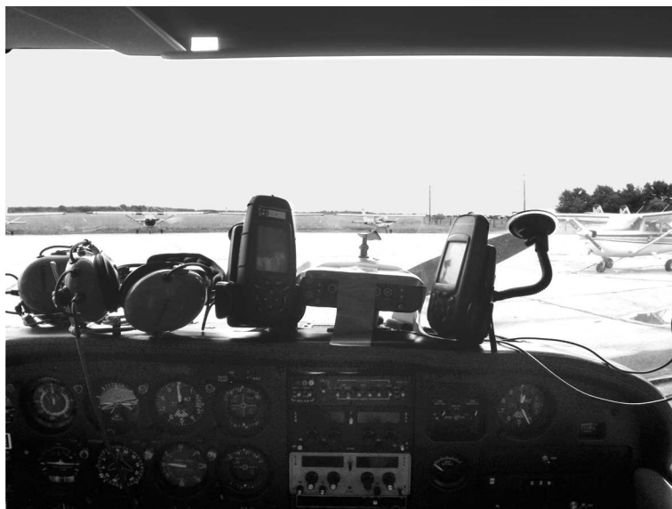
Rysunek 3. Odbiorniki Thales MobileMapper oraz Topcon HiperPro zamontowane w kabinie pilotów samolotu
