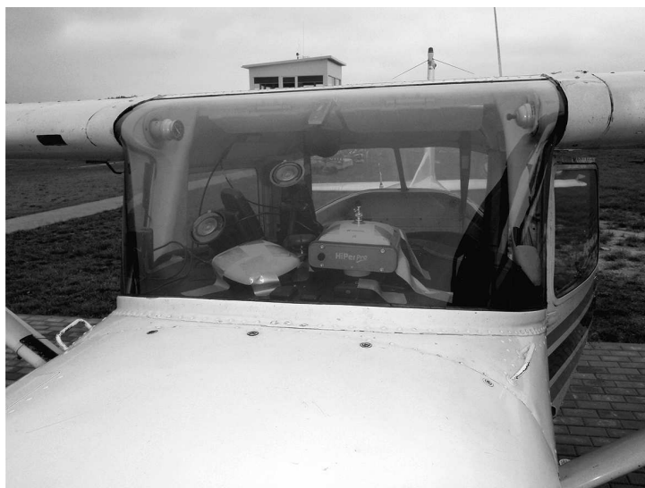
Rysunek 11. Odbiorniki Thales MobileMapper, Topcon HiperPro oraz Javad Alpha zamontowane w kabinie pilota samolotu
