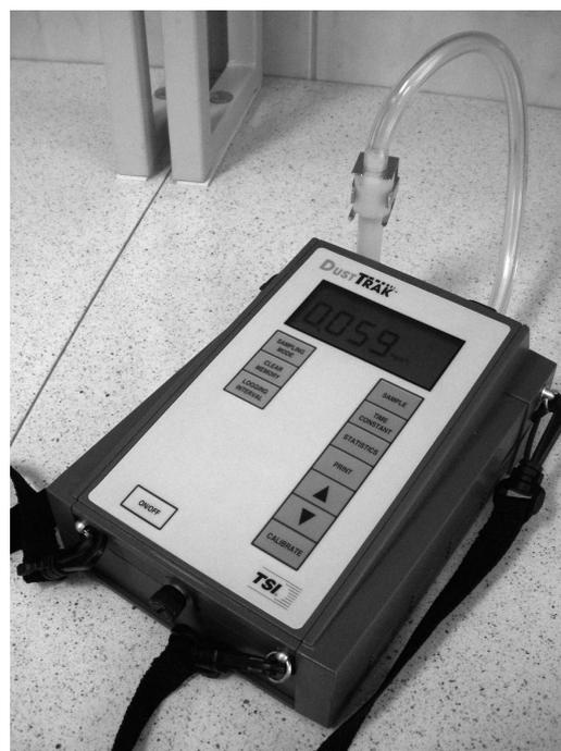
Rysunek 2. Pyłomierz laserowy DustTrack model 8520, firmy TSI (USA)
