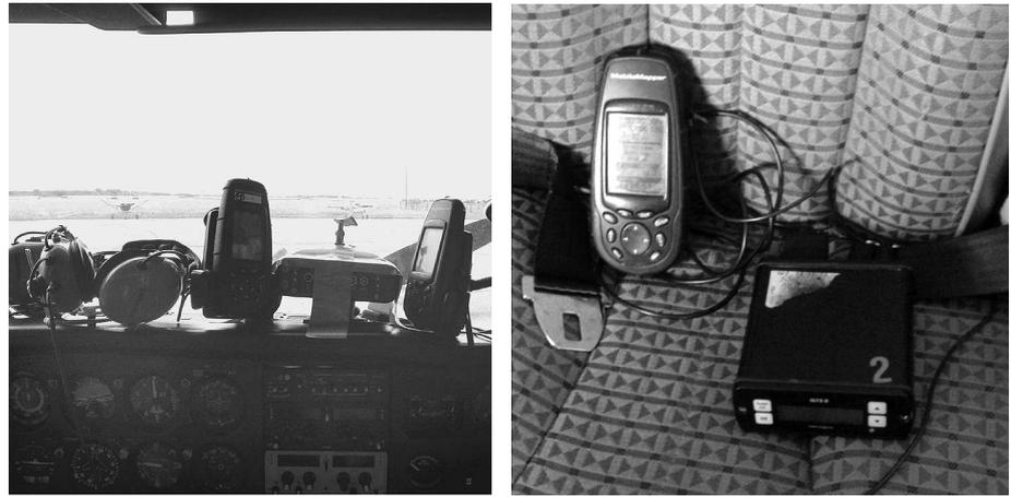
Rysunek 3. Przykładowe rozmieszczenie odbiorników w samolocie Cessna oraz IGTS-R z odbiornikiem Thales MobileMapper
