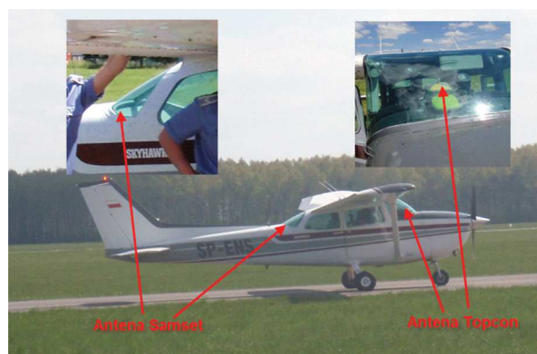
Rysunek 3. Rozmieszczenie anten GNSS podczas lotów testowych
