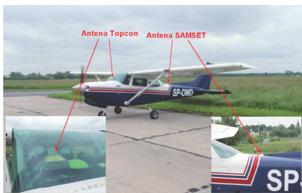
Rysunek 3. Rozmieszczenie anten GNSS podczas lotów testowych
