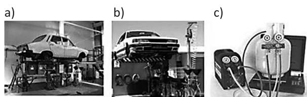
**Rysunek 6.** Osuszanie samochodów – a) stacja z ramą podtrzymującą samochód, b) mobilny system osuszania typ MDS2, c) urządzenie do osuszania układów klimatyzacyjnych
