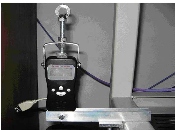
Rysunek 4. Siłomierz zamontowany na ramie
