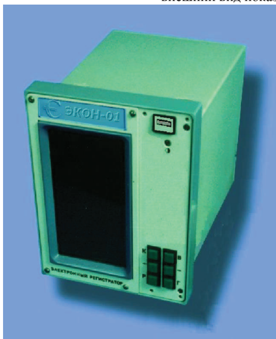
Rys. 10. Wygląd zewnętrzny elektronicznego urządzenia rejestrującego ЭКОН-01 Рис. 10. Внешний вид электронного регистрирующего устройства ЭКОН-01
