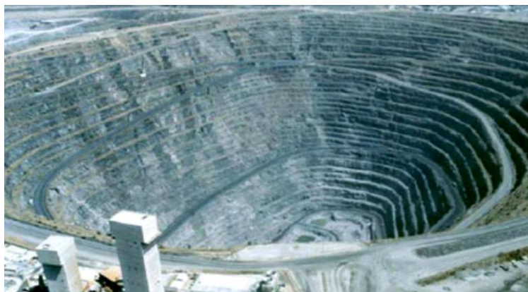
Rys. 2. Odkrywka i wieże wyciągów szybowych kopalni podziemnej Palabora [8]
