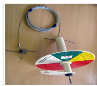
Rys. 2. Obrotowy czujnik tensometryczny telltale Fig. 2. The Rotary Telltale
