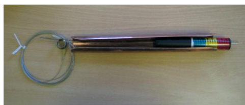
Rys. 1. Pojedynczy czujnik tensometryczny telltale Fig. 1. The Single Height Telltale
