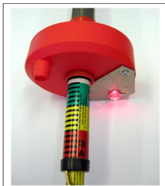
Rys. 16. Czujnik z automatycznym sygnałem ostrzegawczym Fig. 16. Auto Warning Telltale
