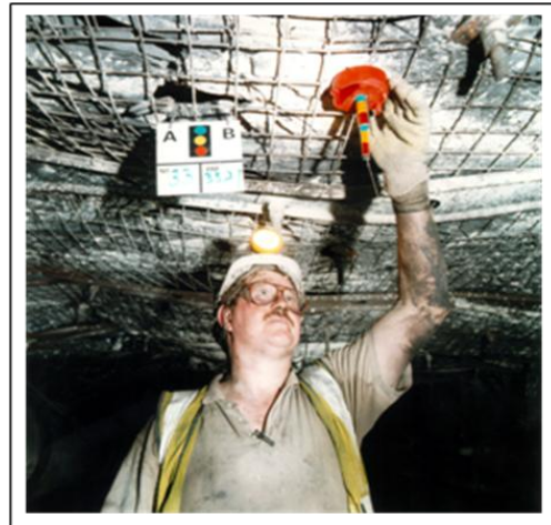
Rys. 4. Odczyt podwójnego czujnika telltale Fig. 4. Reading the Dual Height Telltale
