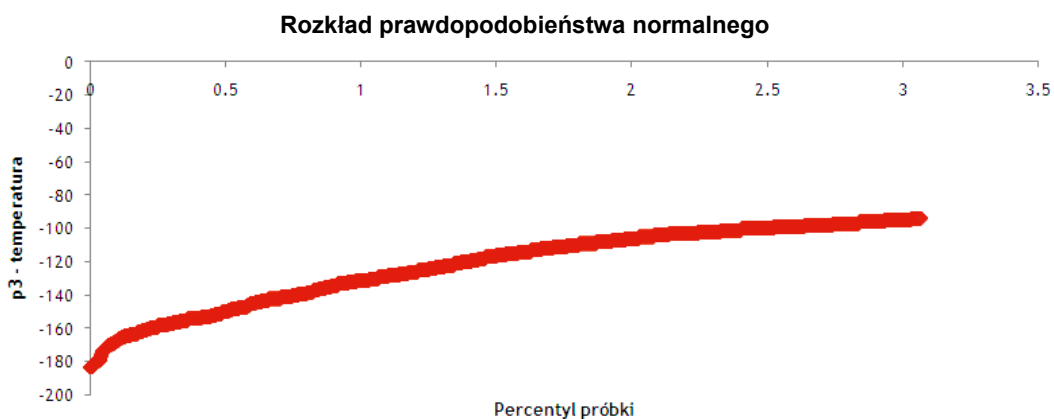
Rys. 9. Rozkład normalny temperatury dla określonej średniej i odchylenia standardowego wg wzoru: Rozkład Normalny ( x , średnia, Odchylenie standardowe)
