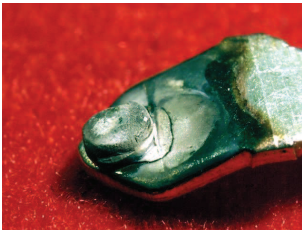
Rys. 4. Widok powierzchni styku rozłącznego, ruchomego, łącznika produkcji angielskiej (po wykonaniu pomiarów energii łuku elektrycznego) dla przypadku prawidłowej konstrukcji styku
