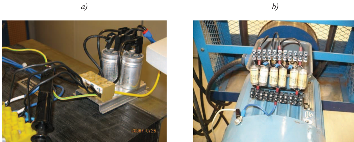
Rys.10. Elementy układu laboratoryjnego do badania właściwości silnikowych filtrów LC w napędzie z przemiennikiem napięciowym zasilanym z sieci nieziemionej typu IT a) realizacja wejściowego filtra pojemnościowego przemiennika częstotliwości, b) realizacja sztucznego wymuszenia doziemnych pojemności pasożytniczych kabla silnikowego
