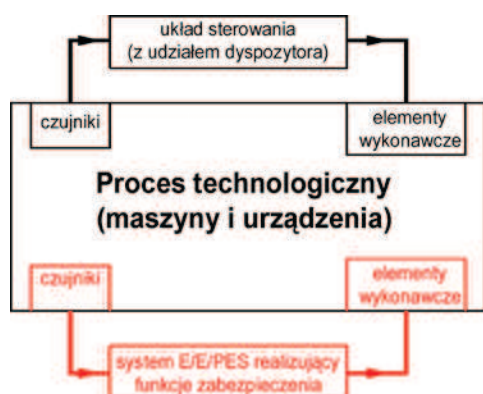
Rys. 3. Ogólny schemat blokowy układu sterowania z zastosowaniem systemu E/E/PES realizującego funkcje bezpieczeństwa
