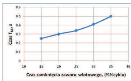
Rys. 16. Zależność czasu (okresu) trwania stanu rozluźnienia ziaren T_{BC} materiału od czasu zamknięcia zaworu wlotowego (czas otwarcia stały – 20% cyklu)
