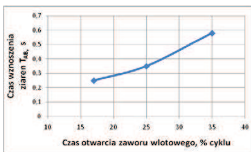
Rys. 15. Zależność czasu (okresu) wznoszenia się ziaren materiału T_{AB} od czasu otwarcia zaworu wlotowego (czas zamknięcia stały – 17% cyklu)
