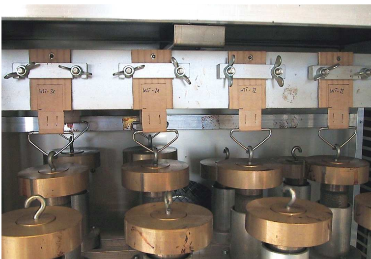
Rysunek 5. Pomiar kohezji kleju samoprzylepnego w podwyższonej temperaturze
