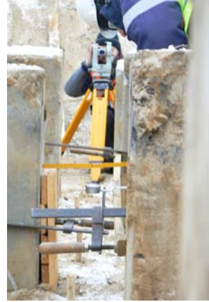
Rys. 8. Stanowisko do badań nośności bocznej pali prefabrykowanych
