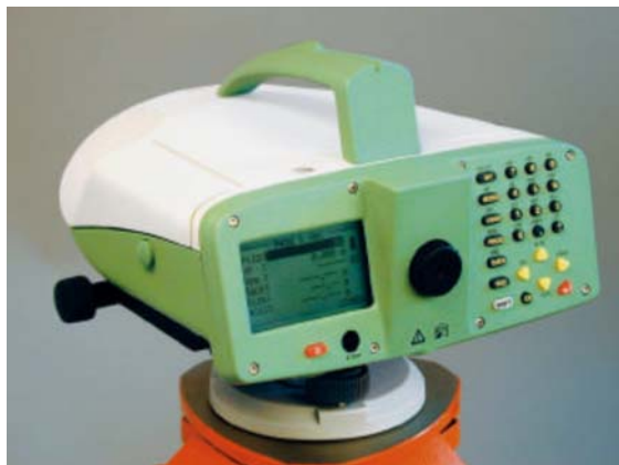
Rys. 2. Niwelatory precyzyjne cyfrowe: a) DNA 03, b) DiNi 0.3
