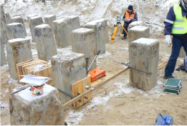
Rys. 8. Stanowisko do badań nośności bocznej pali prefabrykowanych
