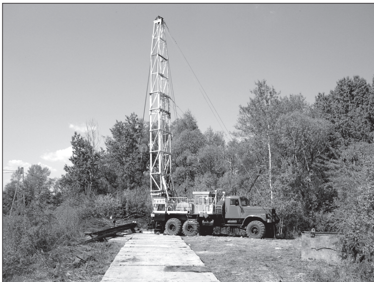
Rys. 1. Sprzęt do wykonywania likwidacji odwiertu
