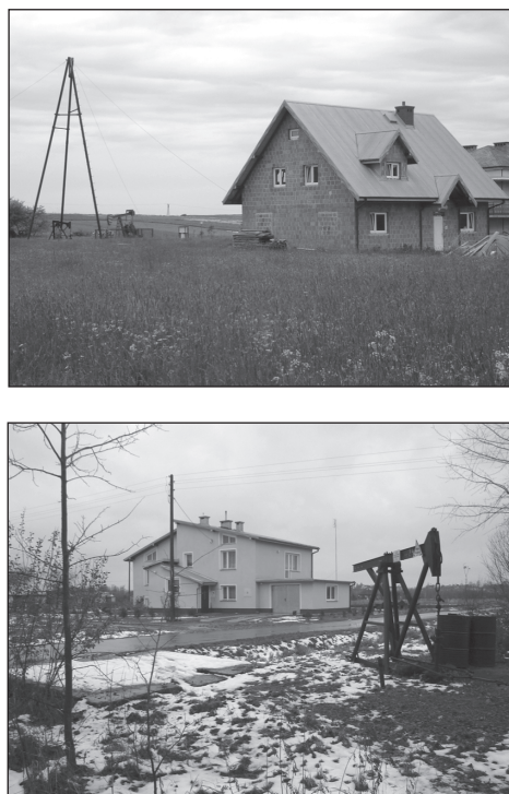
Rys. 5. Odwierty znajdujące się w sąsiedztwie budynków (potencjalnych odbiorców ciepła) – przykłady z Lipinek
