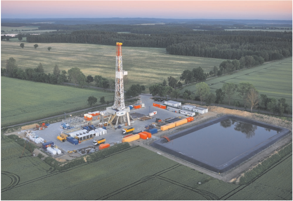
Rys. 1. Widok zagospodarowania wiertni podczas wiercenia otworu za „gazem łupkowym” urządzeniem MASSARENTI model MAS 5000 E [8]
