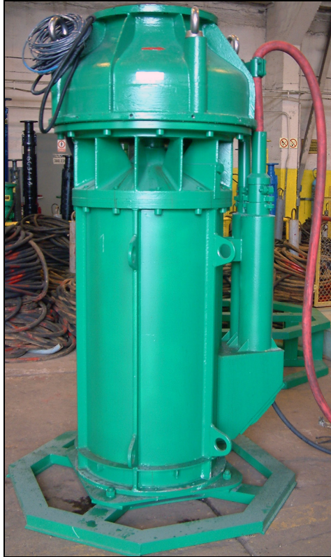
Rys. 15. Konstrukcja pompy typoszeregu OZ [7]
