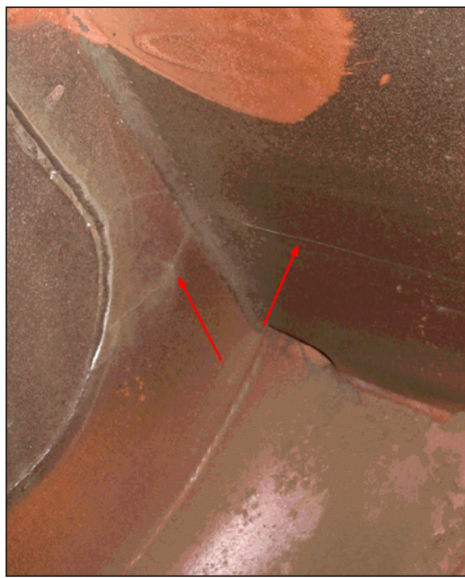
Rys. 6. Przykłady uszkodzeń elementów układu urabiania i napędu koła czerpakowego: a) uszkodzenia zębów w przekładni napędu, b) pęknięcia zmęczeniowe tulei dźwężnej, c i d) pęknięcia piasty koła czerpakowego
