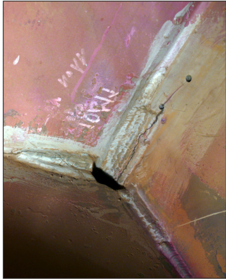
Rys. 6. Przykłady uszkodzeń elementów układu urabiania i napędu koła czerpakowego: a) uszkodzenia zębów w przekładni napędu, b) pęknięcia zmęczeniowe tulei dźwężnej, c i d) pęknięcia piasty koła czerpakowego
