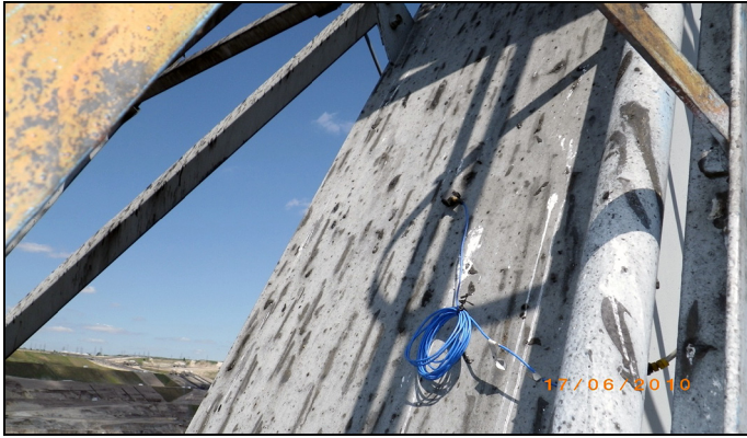
Rys. 7. Czujnik przyspieszeń umieszczony w części środkowej masztu koparki
